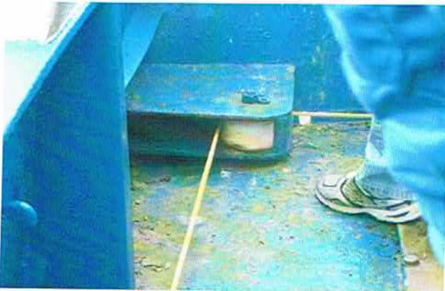
Nylonruller til at beskytte tovet mod slid
